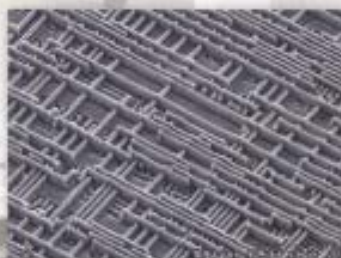
半導体配線の露出処理
